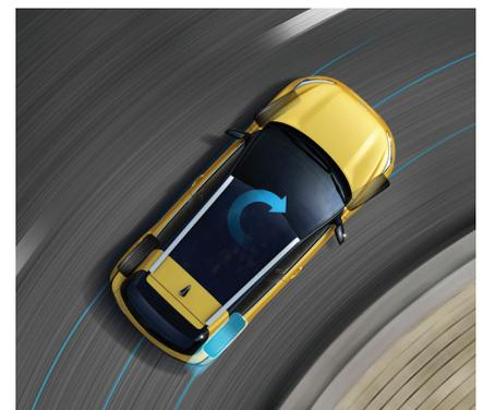
O sistema de gerenciamento de estabilidade do veículo (VSM) trabalha em conjunto com a direção elétrica, assegurando que o Stonic permaneça estável ao frear e fazer curvas simultaneamente.
