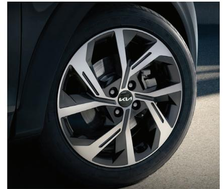
Rodas de liga leve aro 17" com acabamento diamantado e pneus 205/55R17.
